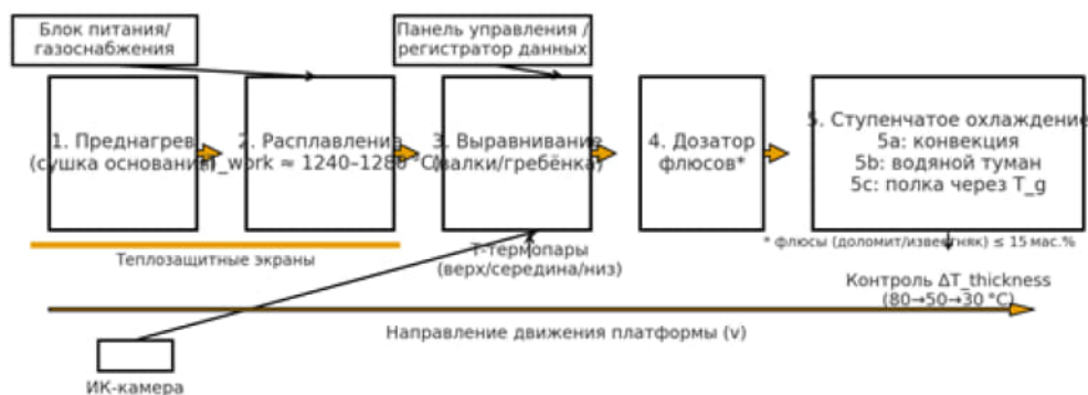
Рисунок 1. Линейно-модульная установка для in-situ термоплавки дорожного слоя. 1 — преднагрев; 2 — расплавление; 3 — выравнивание; 4 — дозатор флюсов; 5 — ступенчатое охлаждение (5а — конвекция; 5b — водяной туман; 5с — полка через T_g ); ИК-контроль и термопары обеспечивают удержание \Delta T_{thickness} 80→50→30 °C.
