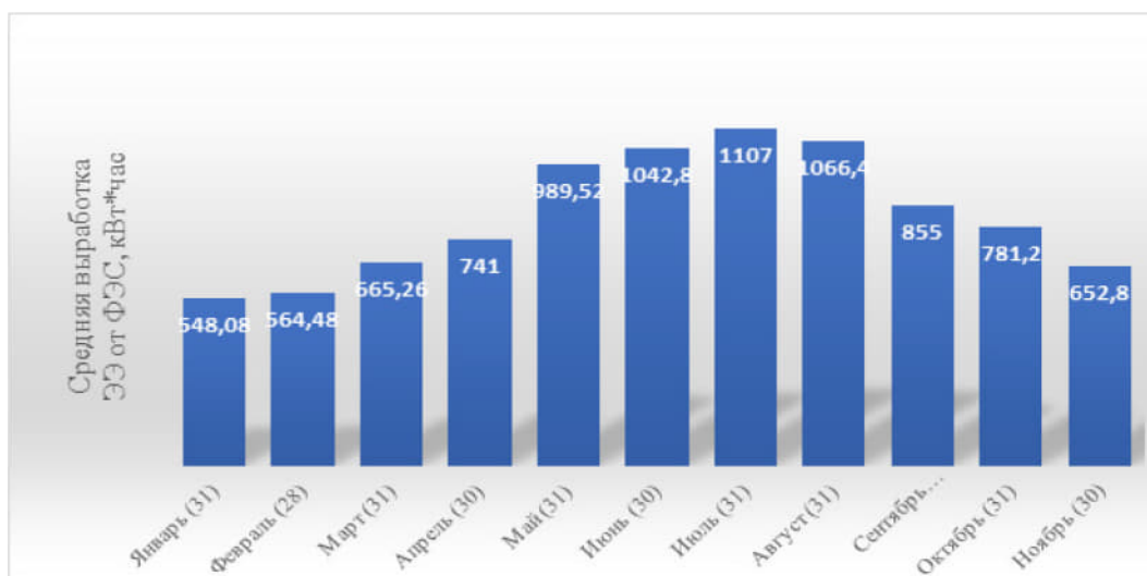
Рис. 6. Средняя выработка электроэнергии от ФЭС с номинальной мощности 5 кВт, средняя за месяц, кВт*час.
