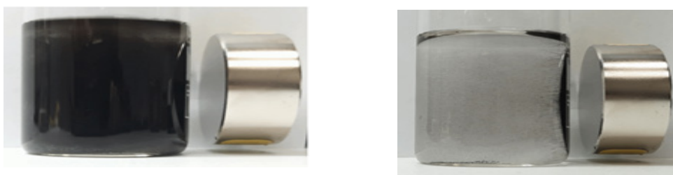
Рис. 3. Фотографии магнитной жидкости с \text{Fe}_3\text{O}_4 -ГК до и после магнитной сепарации (10 масс.%, Nd; 0,1 Тс)
