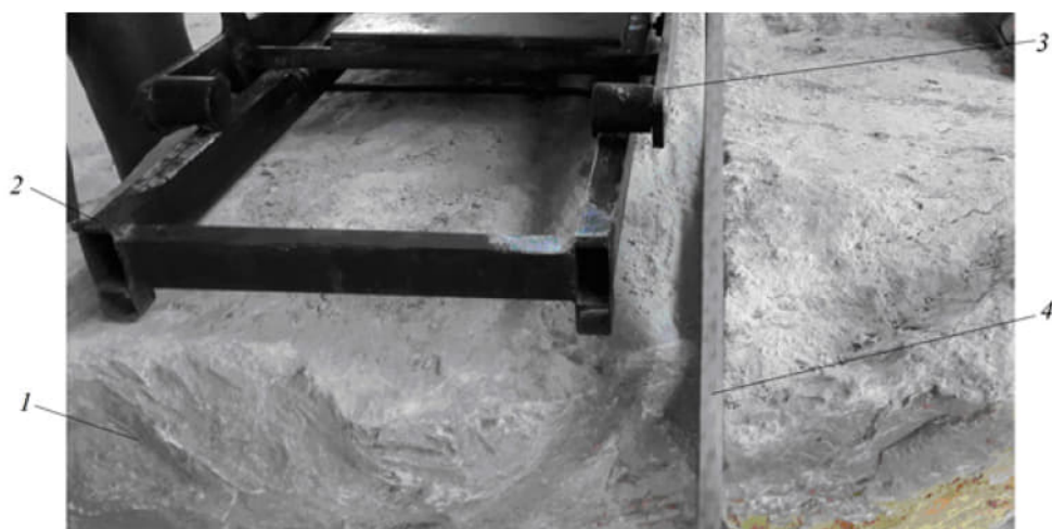
Рисунок 4 - Резание вертикальной щели в блоке камня 1 – блок камня; 2 – рельс машины; 3 – рабочая тележка; 4 – режущая цепь.
